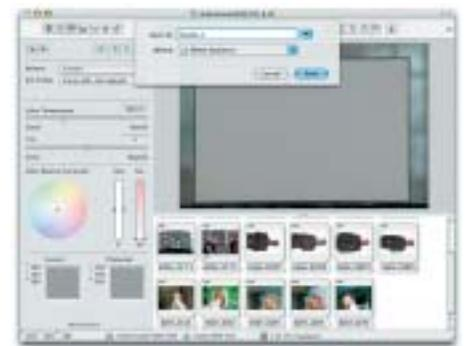
Der Graubgleich erfolgt mit dem Pipettenwerkzeug auf die in der Produktion verwendete Graukarte. Speichern Sie diesen Graubgleich zur späteren Verwendung ab. Dies ermöglicht, später bei diesen Lampen die Lichtfärbung durch z. B. Lampenvorsätze wahlweise zu erhalten (Laden des Graubgleichs) oder zu eliminieren (neuer Graubgleich mit Graukarte)
